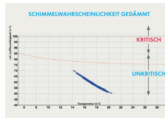
$x = R_{f_{D_{i, \text{bed}}}} \cdot \text{Temp., -Innenwandoberfläche}$  — Grenze für Keimung - Schimmelbildung
