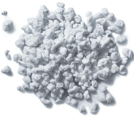
*Perlit hat einen Kristallwassergehalt von 2 bis 5 Prozent, was ihn enorm expansionsfähig macht. In einer Aufbereitungsanlage wird der rohe und gemahlene Perlit bei ca. 1.000 Grad Celsius in einem speziellen Ofen expandiert; auf das 15- bis 20-Fache seines Ursprungsvolumens.*
